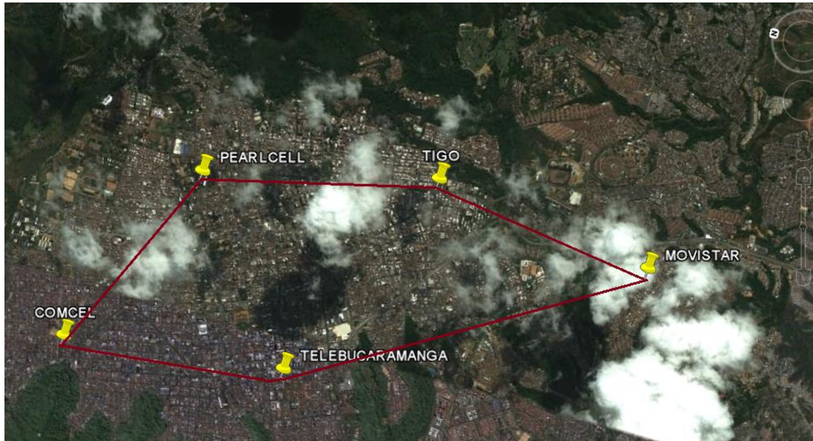
Figura 16. Anillo de Fibra óptica para enlace con otros operadores.
