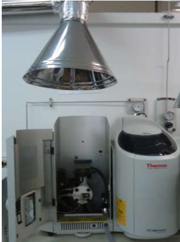
Figura 1. Equipo de absorción atómica Thermo Solar ICE 300, disponible en el laboratorio de investigación de la universidad Santo Tomás, Bucaramanga.
