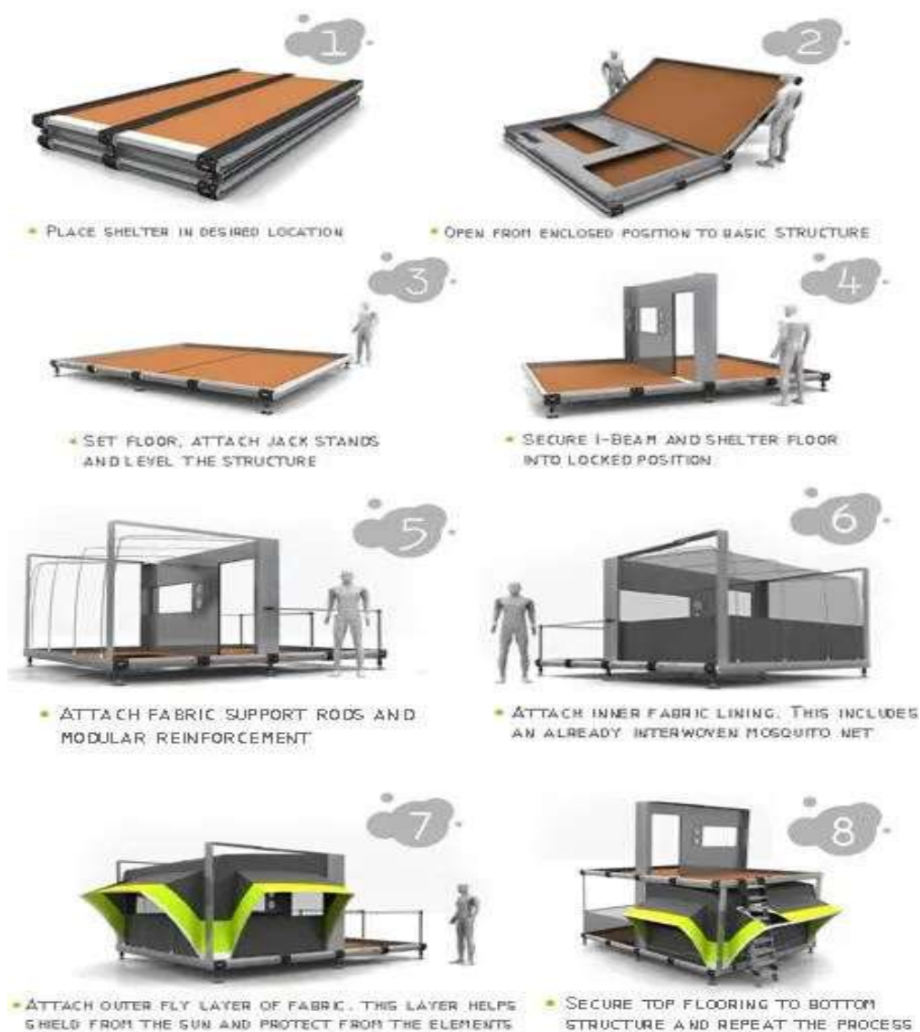
Figura 20 Construcción Shelter Uber
