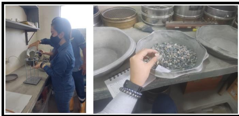
Figura 21 Ensayos de laboratorio interno (T175, caras fracturadas e índice de alargamiento y aplanamiento).
