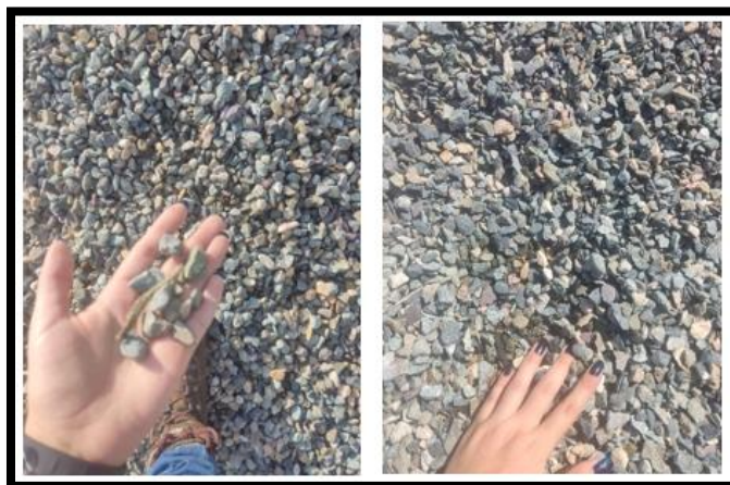
Figura 13 Inspección visual grava 3/4" y 1/2".
