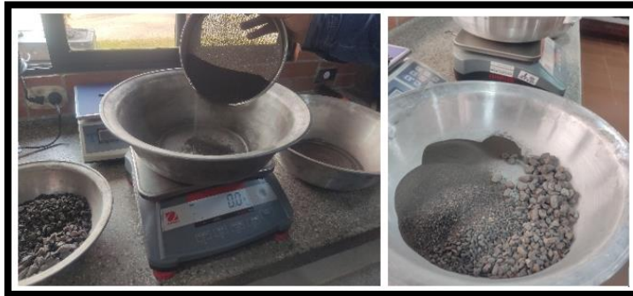
Figura 8 Granulometría de agregados pétreos extraídos de la mezcla asfáltica.
