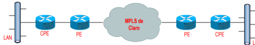
Ilustración 1. Diagrama red MPLS Claro. Tomado de Claro S.A
