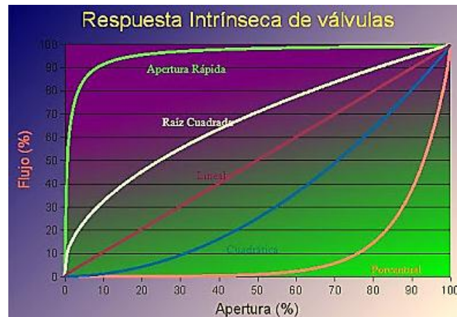
Figura 25 Respuesta intrínseca de válvulas (Flujo Vs Apertura)
