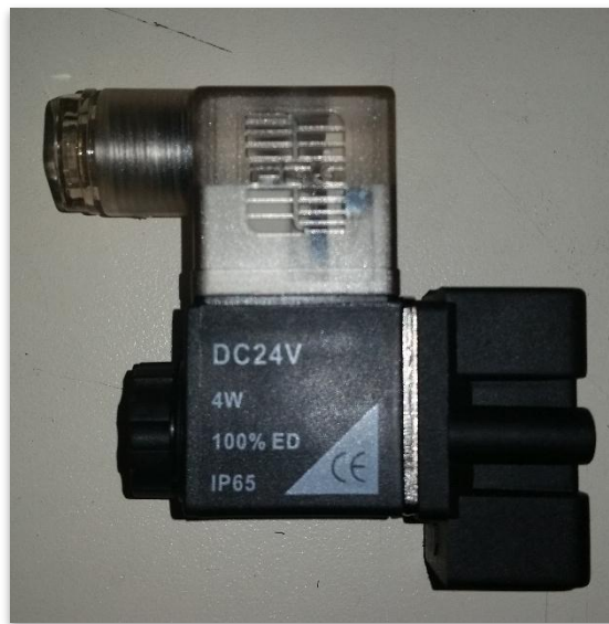
Figura 42. Electroválvula ON/OFF implementada como medio de actuación dentro del dispositivo.
