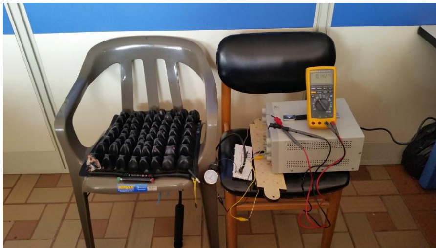
Figura 38. Procedimiento físico de parametrización sensor MPX2050GP
