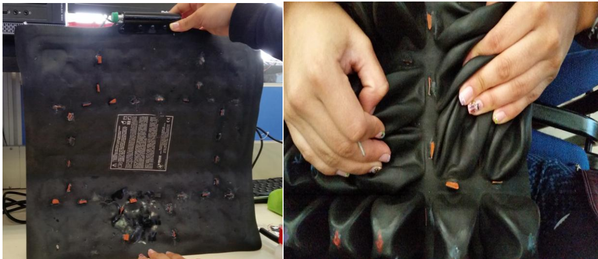
Figura 30. Separación de las celdas del cojín antiescaras para la obtención de dieciséis zonas de presión. Fuente: Castro, A. Mendoza, L.
