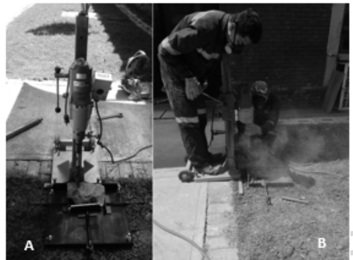
Figura 2. Taladro utilizado para la Perforación de bloques de roca y extracción de núcleos (A). Perforación en seco (B).
