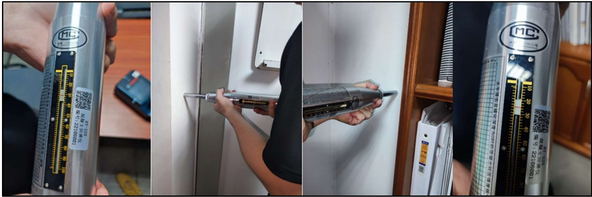
Figura 1. Ejecución del Ensayo de Esclerometría
