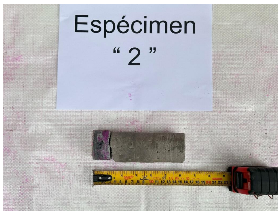
Ilustración 18. Espécimen 02 de núcleo, ensayo carbonatación.
