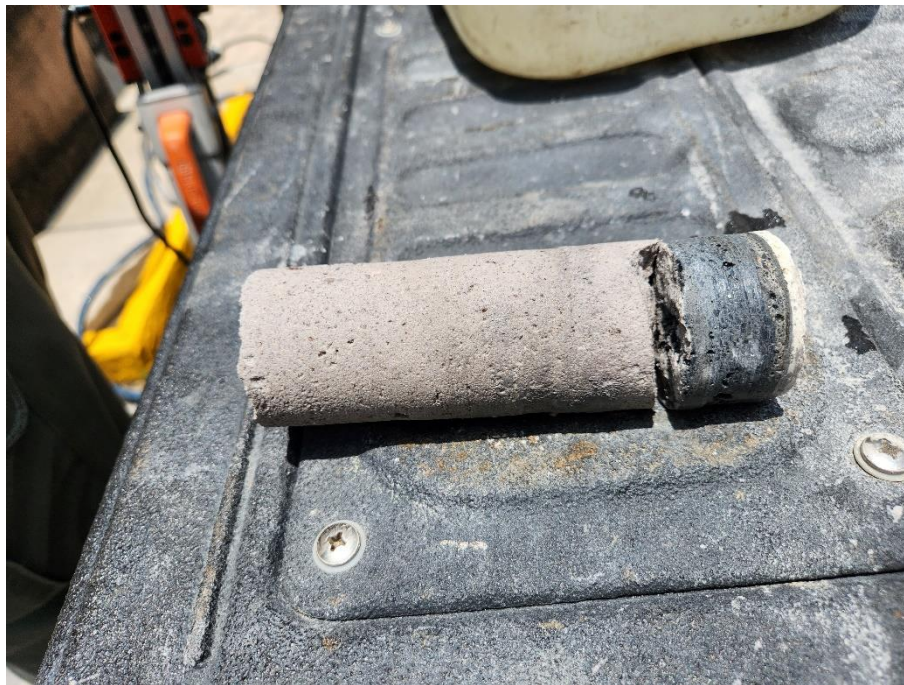
Ilustración 11. Obtención de muestra por medio de extracción de núcleos.
