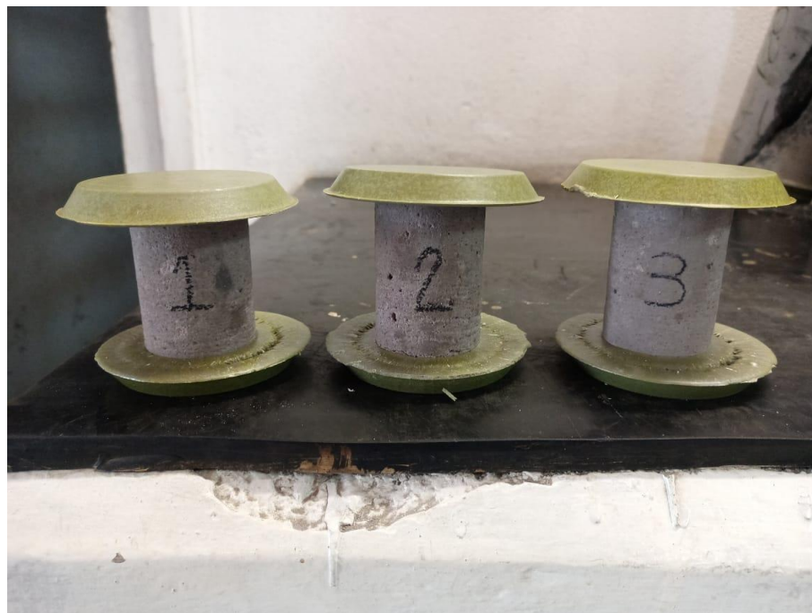
Ilustración 21. Especímenes de núcleos cabecados con mortero de azufre.
