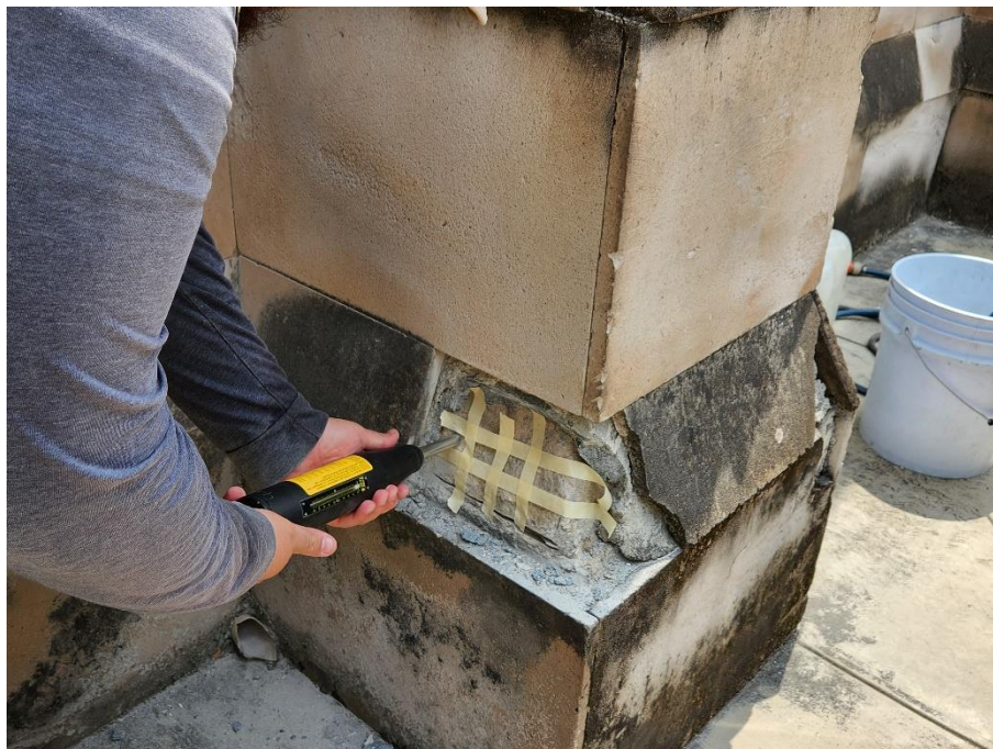
Ilustración 14. Determinación de índice de rebote utilizando el dispositivo de martillo de rebote, esclerómetro.
