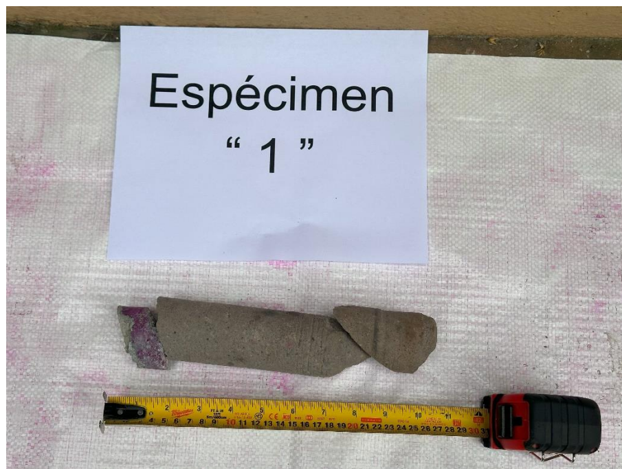
Ilustración 17. Espécimen 01 de núcleo, ensayo carbonatación.
