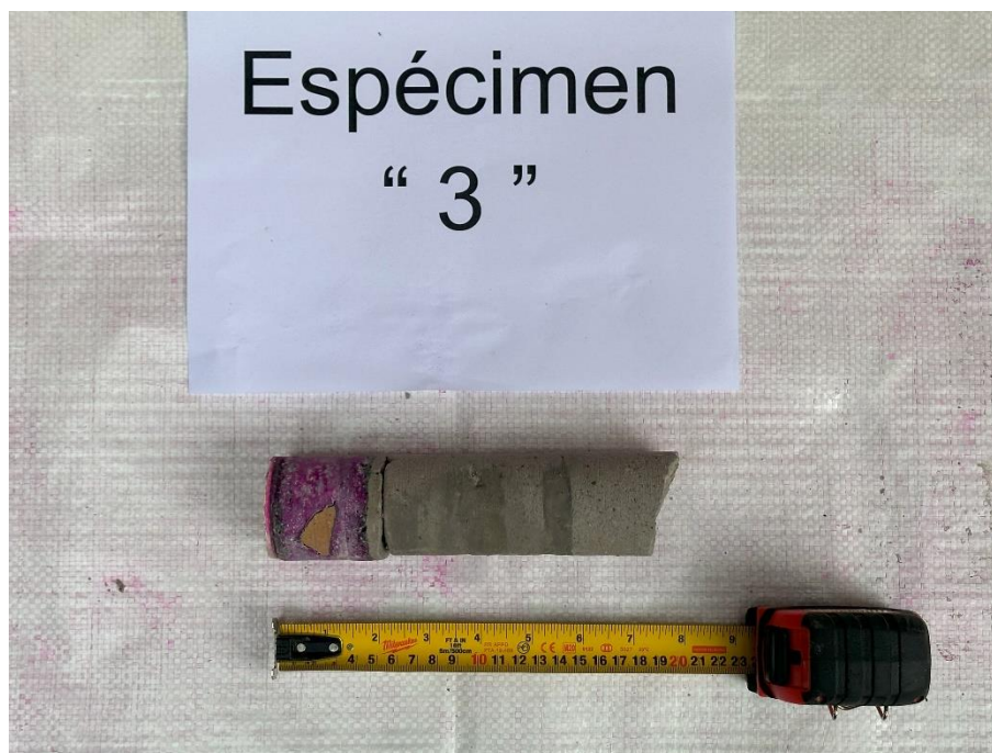
Ilustración 19. Especimen 01 de núcleo, ensayo carbonatación.
