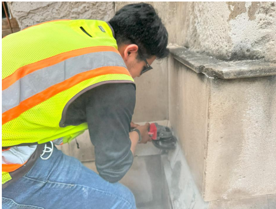
Ilustración 13. Corte para la realización de prueba con esclerómetro.
