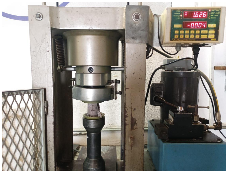
Ilustración 23. Ensayo de resistencia a la compresión Espécimen 01.
