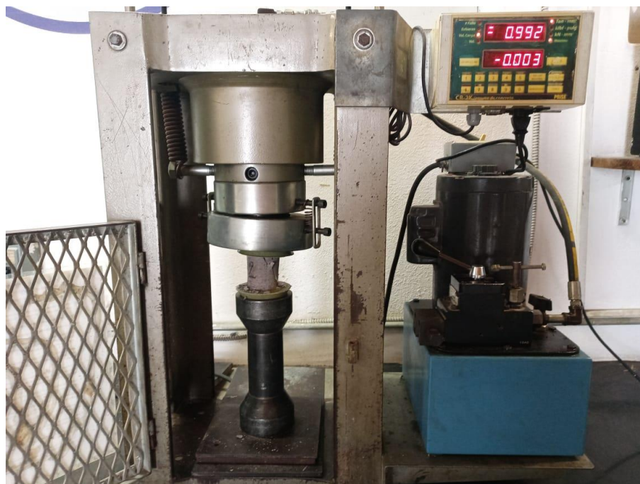
Ilustración 24. Ensayo de resistencia a la compresión Espécimen 01.
