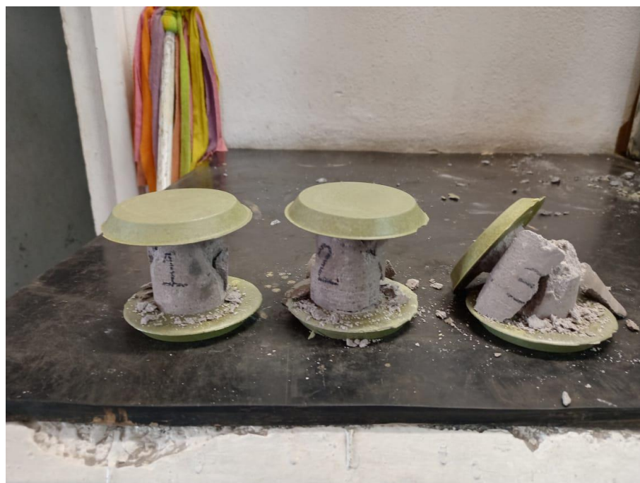
Ilustración 22. Especímenes ensayados para resistencia compresión.
