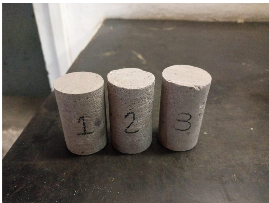
Ilustración 20. Especímenes de núcleos preparación para cabeceo.
