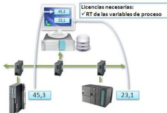
Figura 11. Topología sistema Monopuesto
