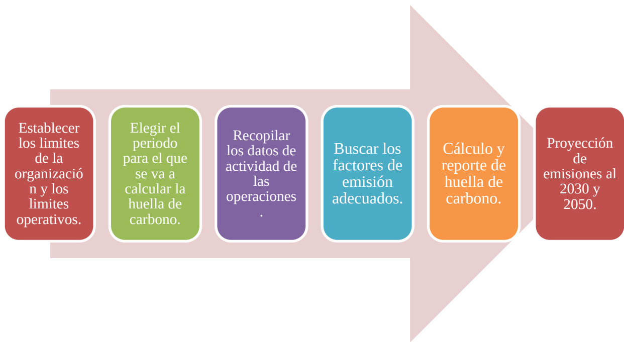
Figura 9. Proceso cálculo huella de carbono
