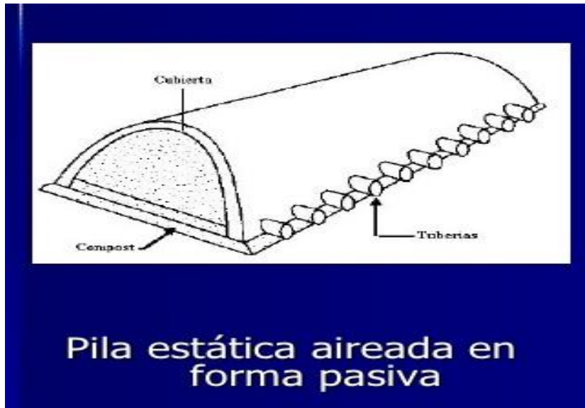
Figura 3. Pila estática aireada de forma pasiva. Tomado de
