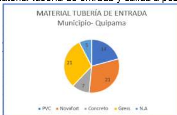
Ilustración 12. Material tubería de entrada y salida a pozos de inspección.
