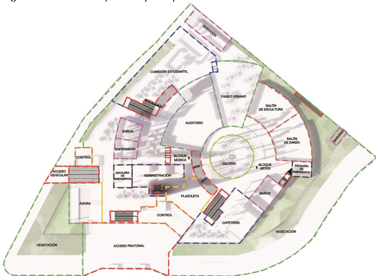
Figura 105. Distribución funcional planta primer nivel.
