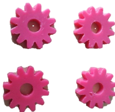
Figura 45 Inyección de múltiples engranajes
