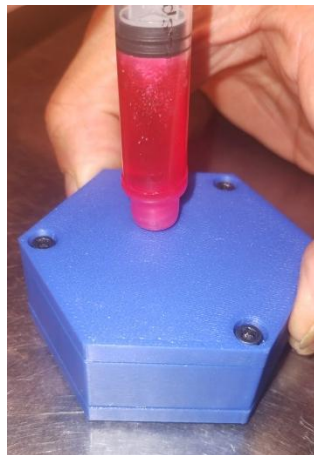
Figura 42 Inyección de material al molde mediante jeringa
