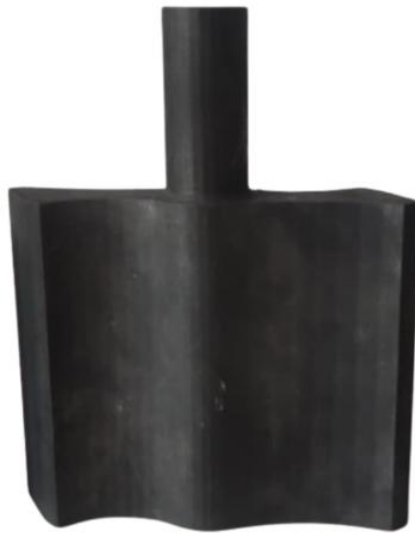
Ilustración 31. Rotor impreso en 3D, para fundición.
