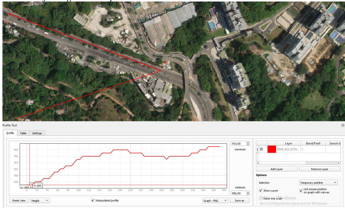
Figura 56. Perfil longitudinal Aplicativo 3
