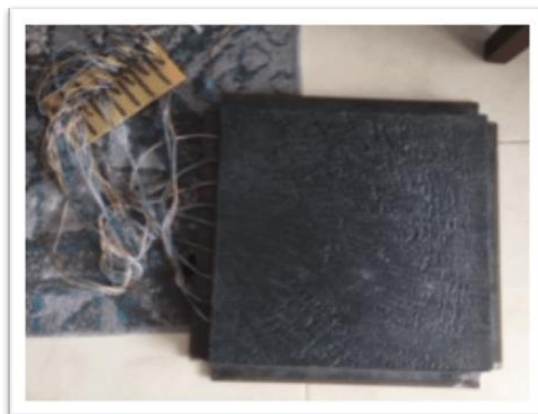
Figura 10. Baldosa piezoeléctrica construida según el diseño y materiales seleccionados. Por Arévalo, Lamprea & Pérez, 2019.
