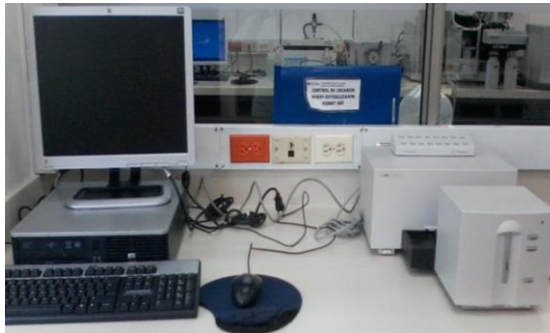
Figura 4. Espectrofotómetro UV-Vis Agilent 8453, empleado para la determinación de azufre y fósforo.
