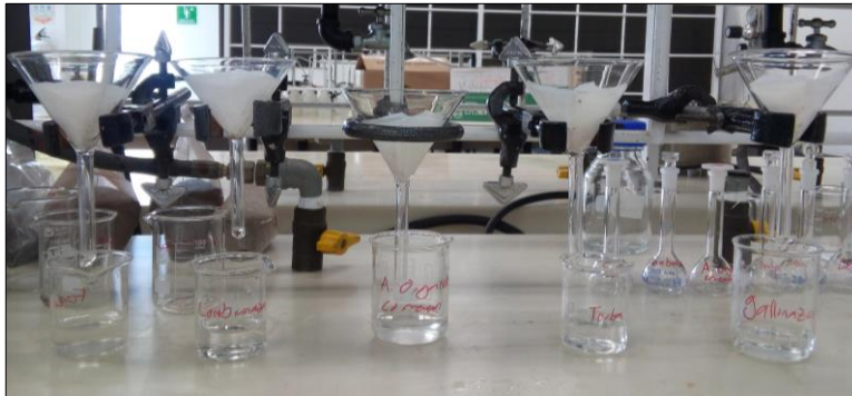
Figura 12. Filtrado de las muestras de abono.
