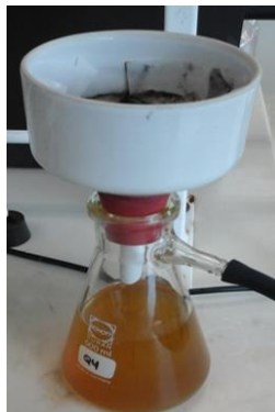
Figura 9. Filtración con acetato de amonio.
