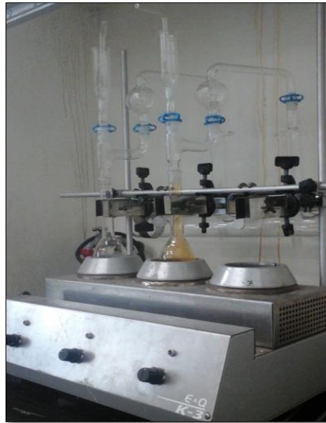
Figura 11. Montaje de Kjeldahl, para la determinación de nitrógeno.
