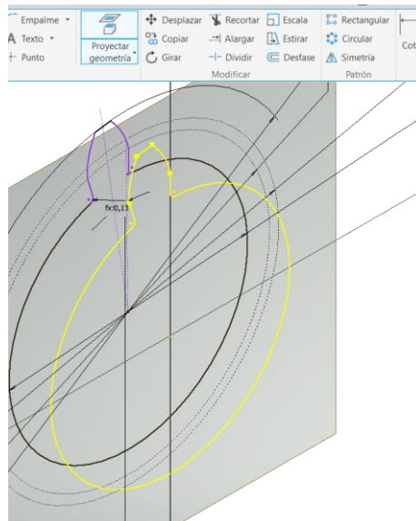
Figura 50. Proyección del perfil del diente en el plano de trabajo.
