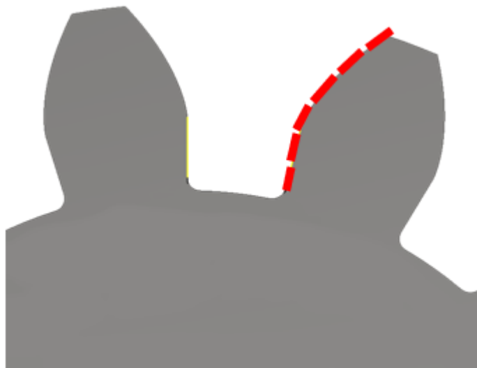
Figura 24. Representación gráfica aproximada de las posiciones de la herramienta con respecto a la involuta.
