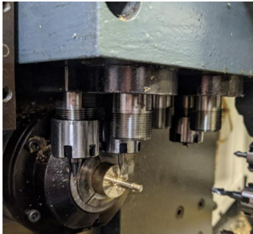
Figura 27. Herramienta ISCAR montada en el Slot 8.
