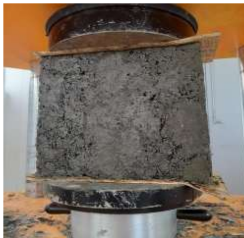
Figura 13 Plaqueta prefabricada con refuerzo al 0,95% de macrofibra.
