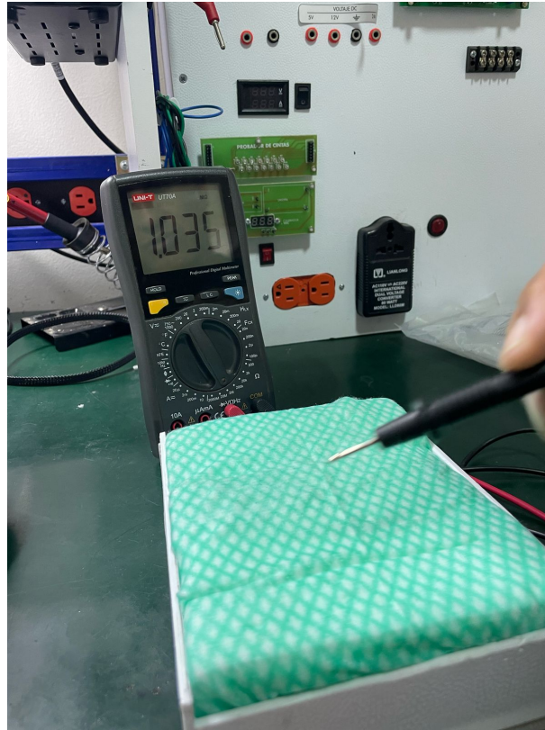
FIGURA 73: Medición de impedancia Ohms( \Omega ) del módulo de pruebas simulando conductividad del tejido
