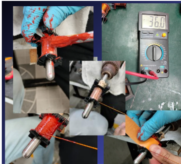
FIGURA 7: Creación de transformador HF obtenida del autor
