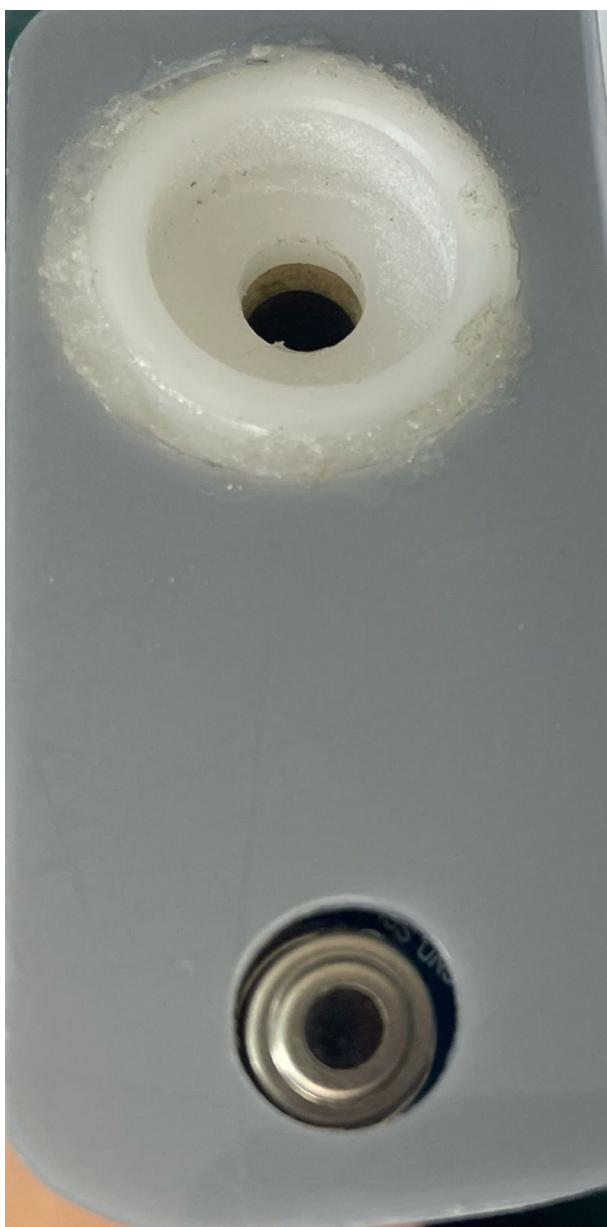
FIGURA 71: Electrodo Emisor con sensor de temperatura
