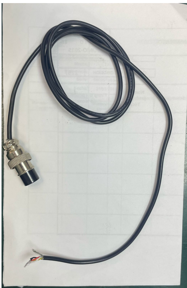
FIGURA 70: Cable de placa emisora
