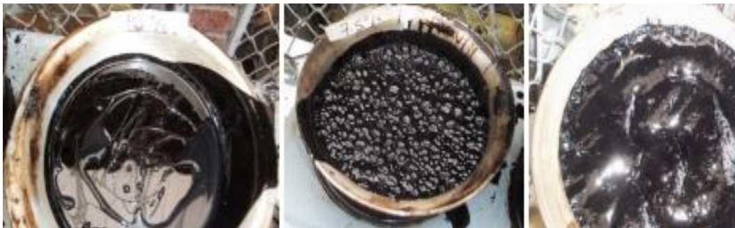
Figura 18. Asfalto espumado producto de mezclarlo con el aditivo a 80°C durante un minuto.
