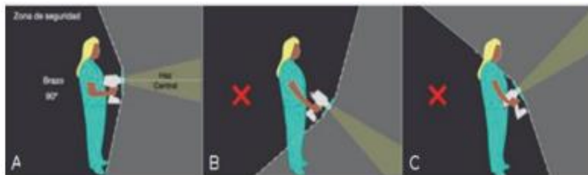
Figura 5. Influencia del ángulo de estabilización del rayo X portátil. uso del disco de retrodispersión.
