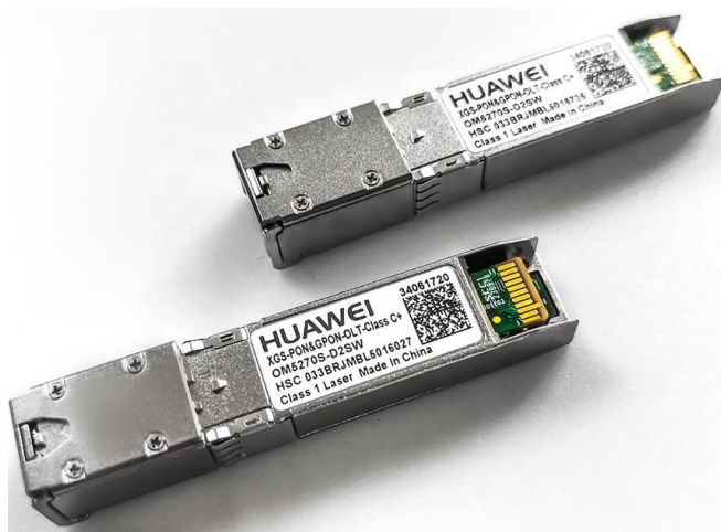
Figura 15. Módulo Óptico SFP XGS-PON&GPON OLT Class C+ (Huawei Technologies Co., s.f.)
