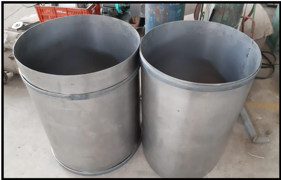
Figura 26. Láminas con refuerzo
