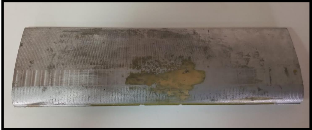
Figura 61. Álabes con relleno de masilla para carro.
