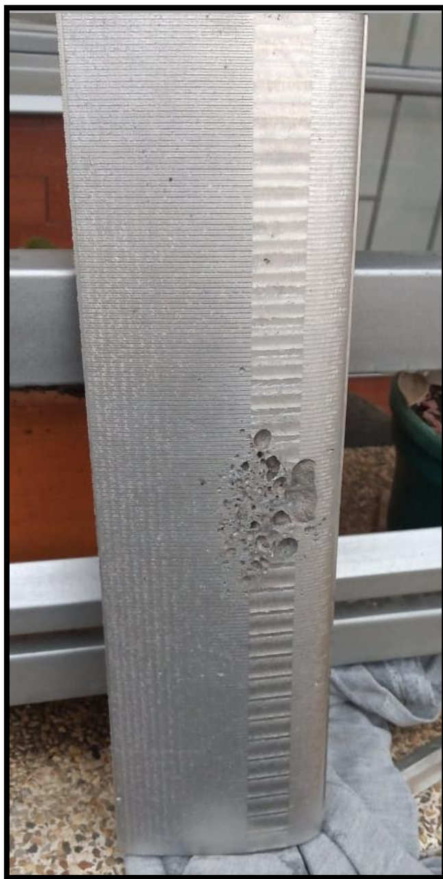
Figura 60. Porosidades sobre la pieza final.
