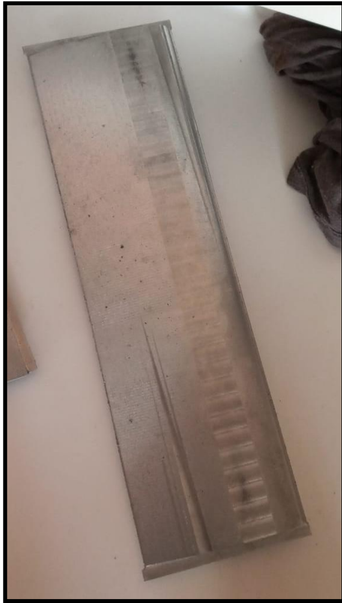
Figura 59. Defectos de mecanizado sobre la pieza final.
