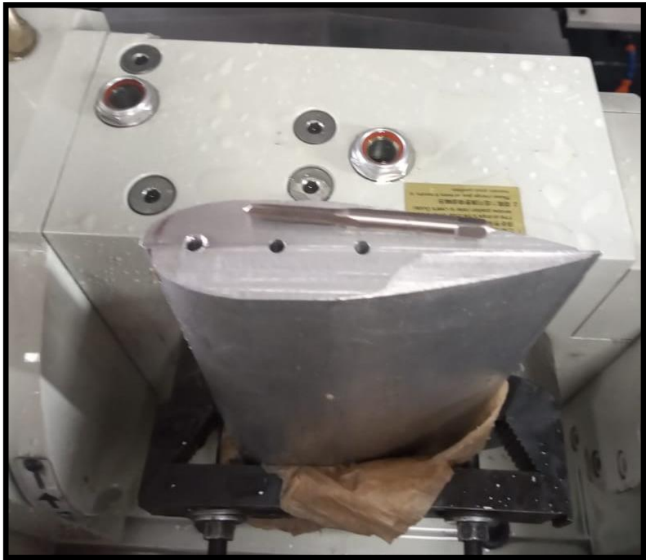
Figura 54. Agujeros sobre la cara superior del álabe.
