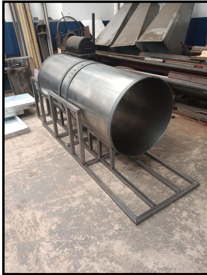
Figura 29. Estructura metálica de soporte.
