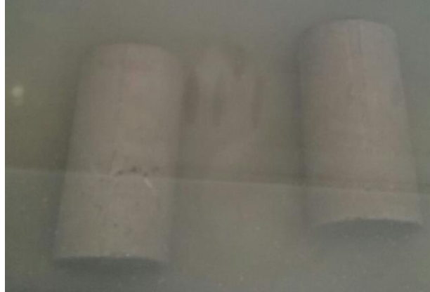
Figura 15. Curado de especímenes de concreto
