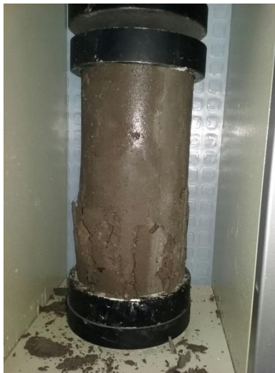
Figura 17. Prueba de resistencia a la compresión del concreto
