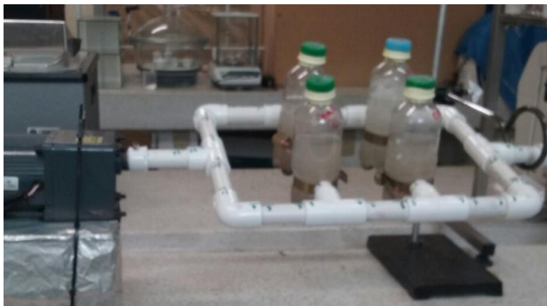
Figura 18. Montaje para agitación rotatoria, TCLP
