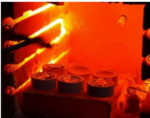
Figura 7. Ingreso de materias primas del proceso de copelación a la mufla precalentada
