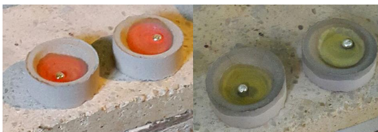
Figura 8. Botón oro-plata (Doré) antes y después del enfriamiento
