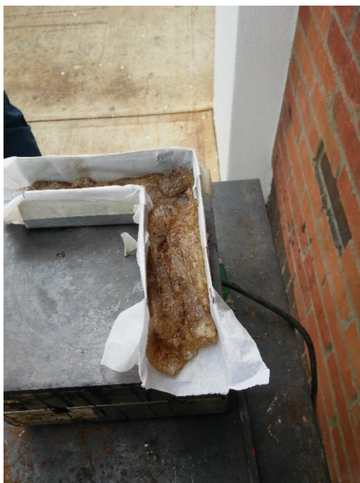
Figura 44. Moldeo de PET fundido por medio de estufa eléctrica
