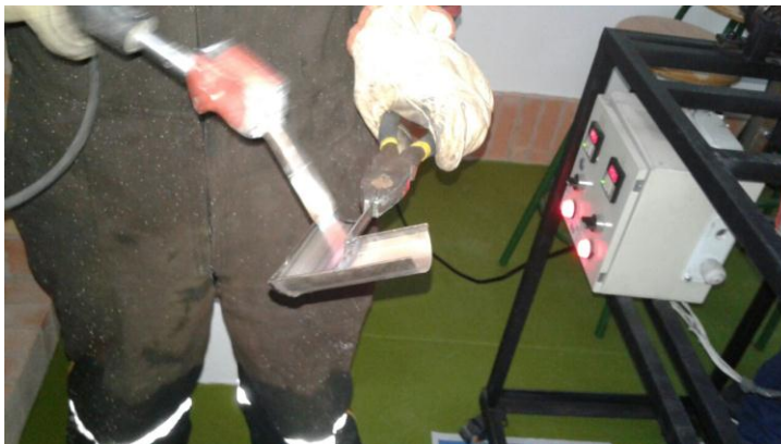
Figura 21. Calentamiento de extrusora para polímeros PET y de molde para uniones mediante soplete
