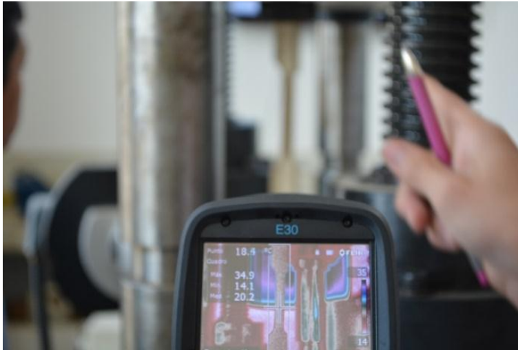
Figura 13. Termografía aplicada al ensayo de tracción
