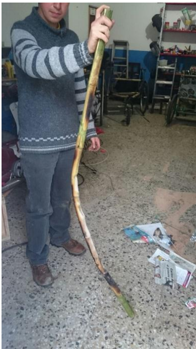
Figura 16. Doblado de bambú terminado
