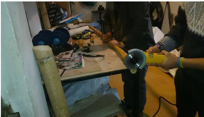
Figura 6. Corte de bambú
