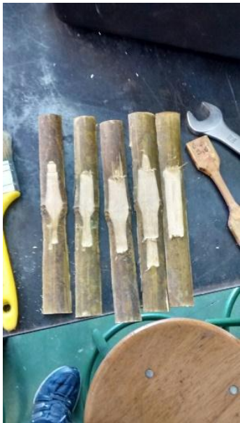
Figura 8. Fabricación de probetas para ensayo de tracción
