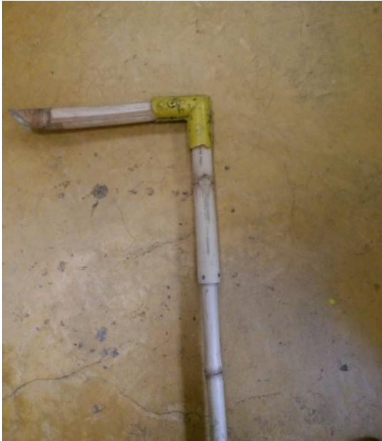
Figura 24. Unión ángulo a partir de polímeros PET para dos secciones de bambú
