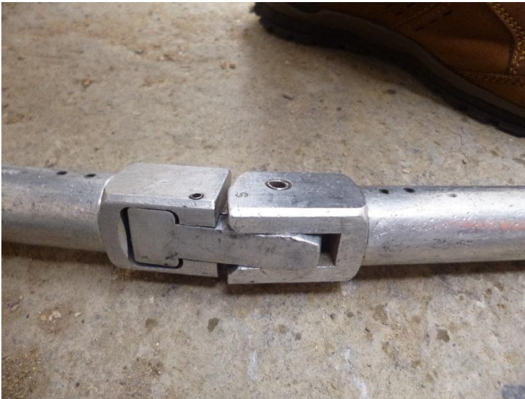
Figura 28. Broches cerrados de la camilla cuchara propiedad de la Cruz Roja Colombiana Seccional Tunja
