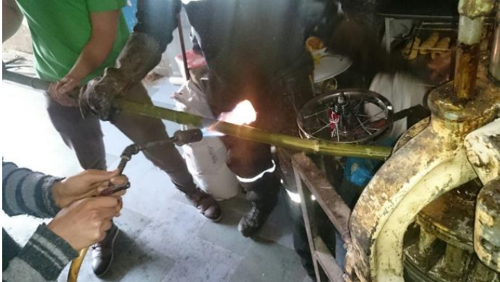
Figura 15. Doblado de bambú por llama directa
