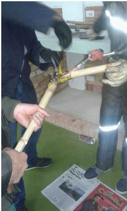
Figura 23. Aplicación de PET extruido en los moldes precalentados para una unión de bambú
