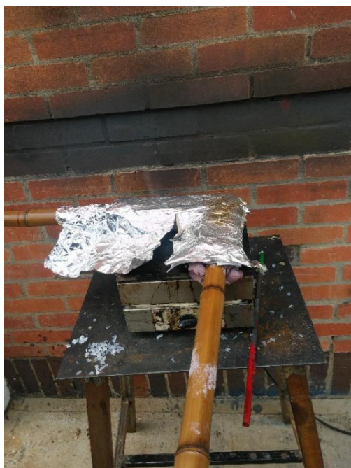
Figura 45. Ensamblaje de las juntas en bambú durante el moldeo de la unión en PET
