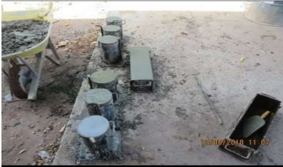
imagen 36. Elaboración de especímenes de concreto
