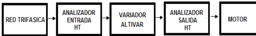
Figura 38 Esquema del experimento Fuente: Elaboración propia
