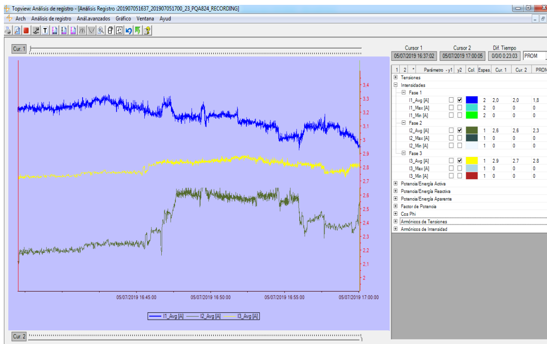
Ilustración 17 Corrientes de línea analizador de salida Fuente: Tomado del programa TOPVIEW
