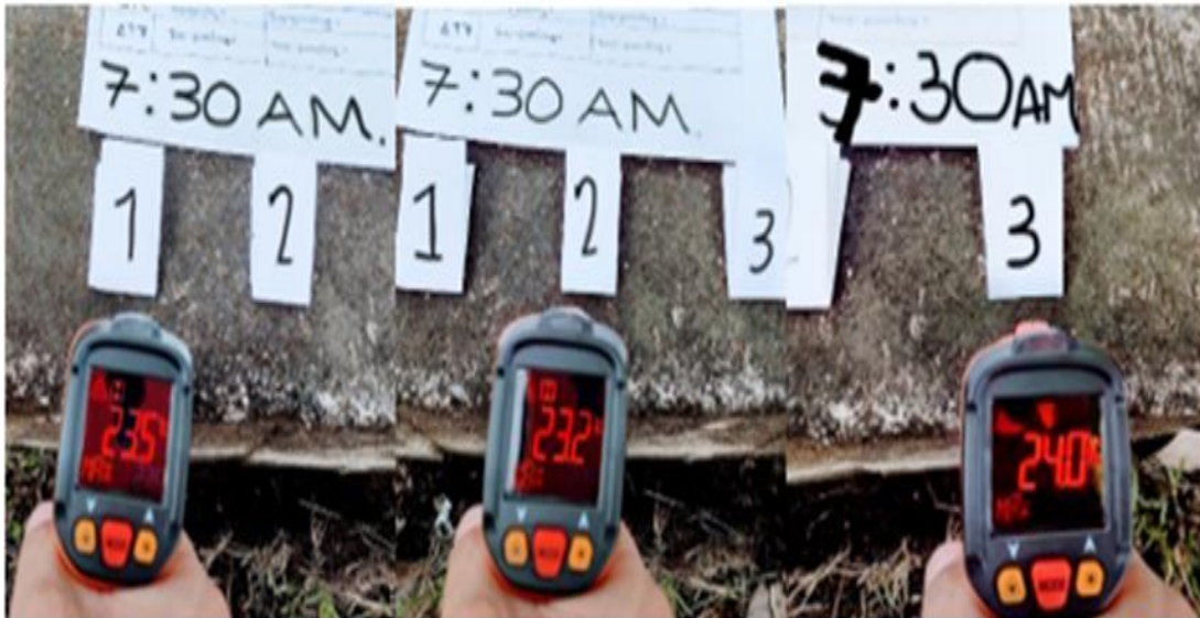
Figura 14. Toma temperatura cara superior e inferior losa de 20 cm, 7:30 am
