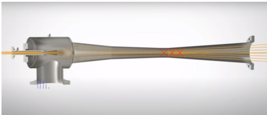
Figura 3. Inyector de Vapor en vacío. Eyector - Sistemas de Vacío. Bernoulli (Director). (2016). [Video/DVD] https://www.youtube.com/watch?v=QSduaoO5xOY
