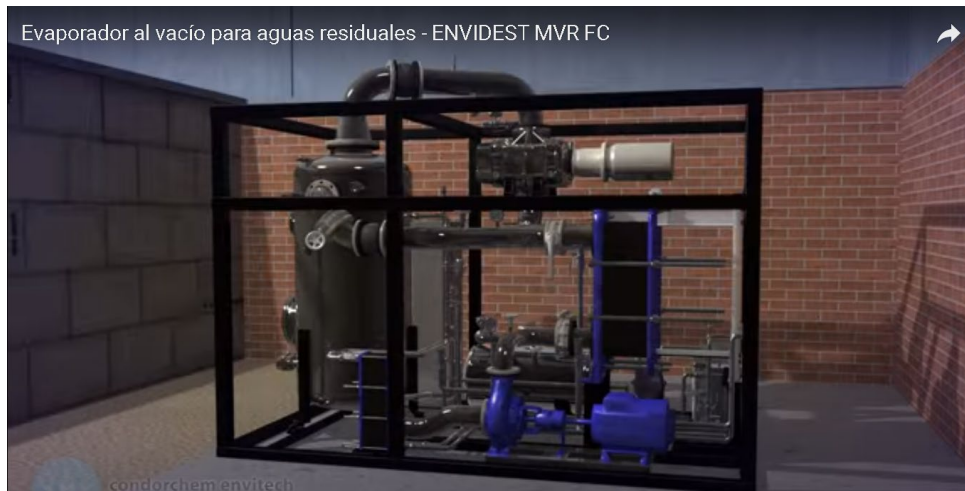
Figura 12. Evaporador al Vacío para Aguas Residuales. Condorchem Envitech (Producer), & . (). Evaporador al vacío para aguas residuales - ENVIDEST MVR FC. [Video/DVD] https://www.youtube.com/watch?v=cZsbFi4R0qU
