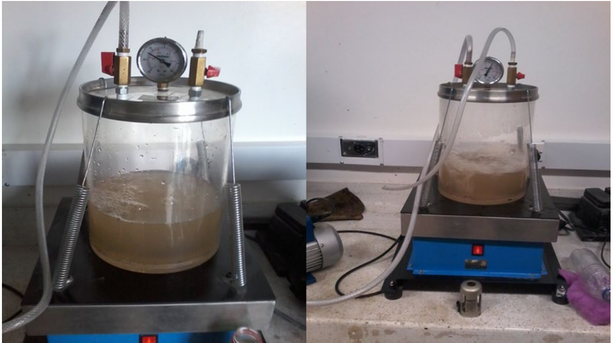
Figura 15. Ensayos de evaporización con diferentes temperaturas. La izquierda es a temperatura ambiente 19° c y la de la derecha ha sido calentada el agua gris con resistencia a 60 °C. Tomada de: autoría propia
