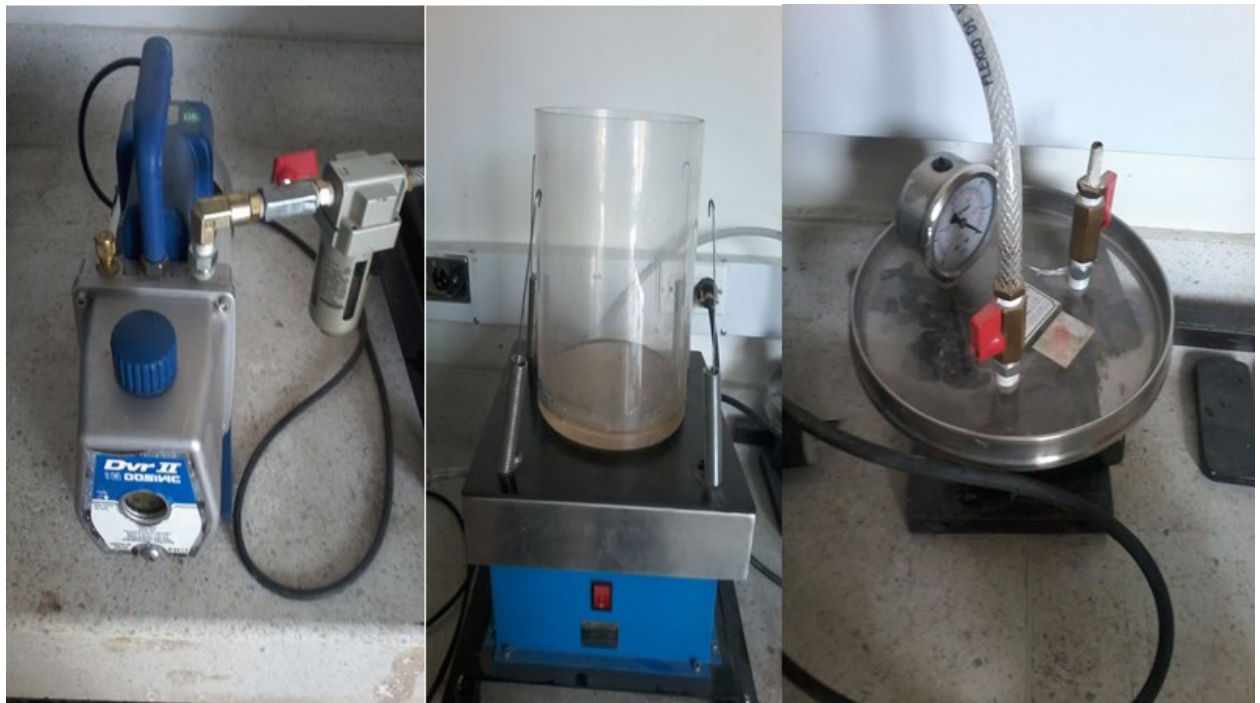
Figura 14. Componentes del Prototipo. equipo rice: izquierda es la Bomba de vacío (Ref. PA 85), en la mitad se encuentra el picnómetro con 6000 g de capacidad y la Tapa de agua, y a la derecha se encuentra el vacuómetro graduado de 0 a 30 in Hg (700 mm Hg) y sus correspondientes mangueras y llaves de presión. Autoría Propia
