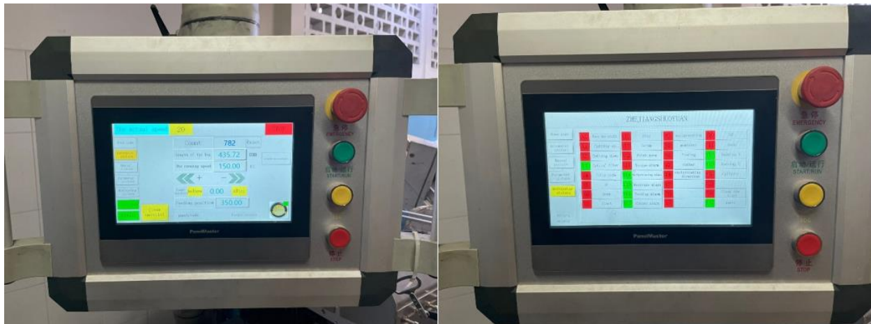
Figura 12 Pantalla de control maquina empacadora
