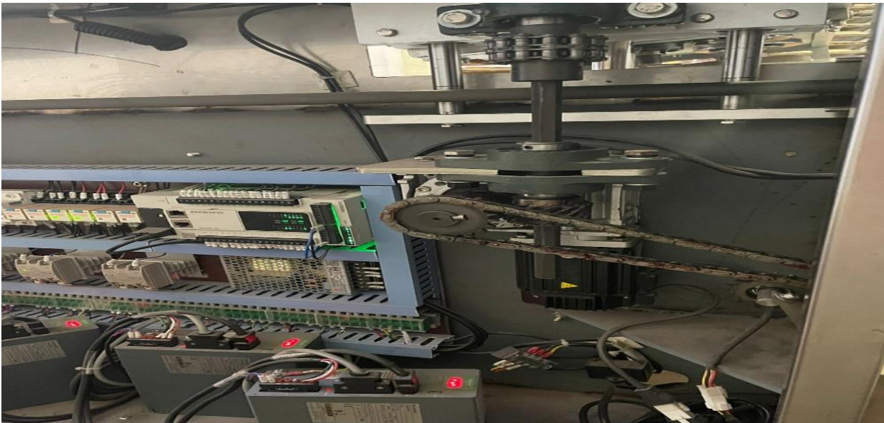
Figura 10 Mecanismos y sistema de control maquina empacadora
