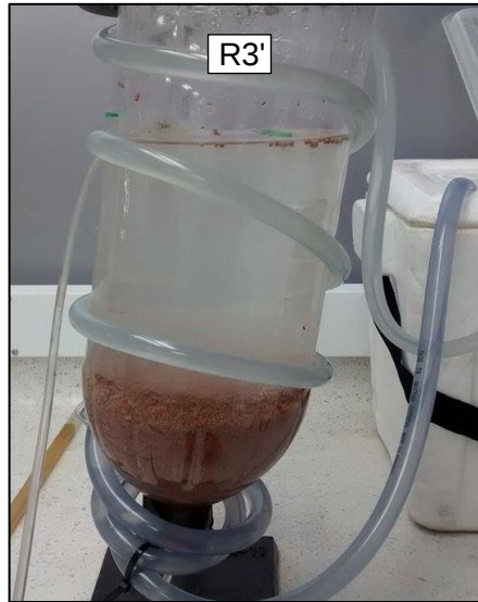
Figura 18. Reactor anaerobio de flujo ascendente de lecho fijo con lodo granular, R3'
