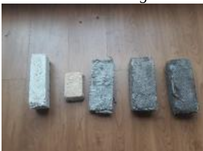
Figura 8. Productos mínimos viables de ladrillo ecológico de cáñamo industrial.
