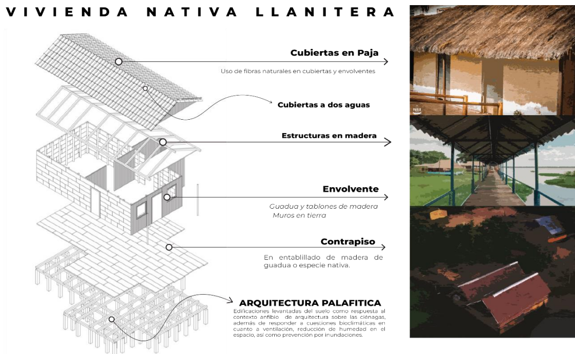
Figura 40. Características de la vivienda nativa llanitera
