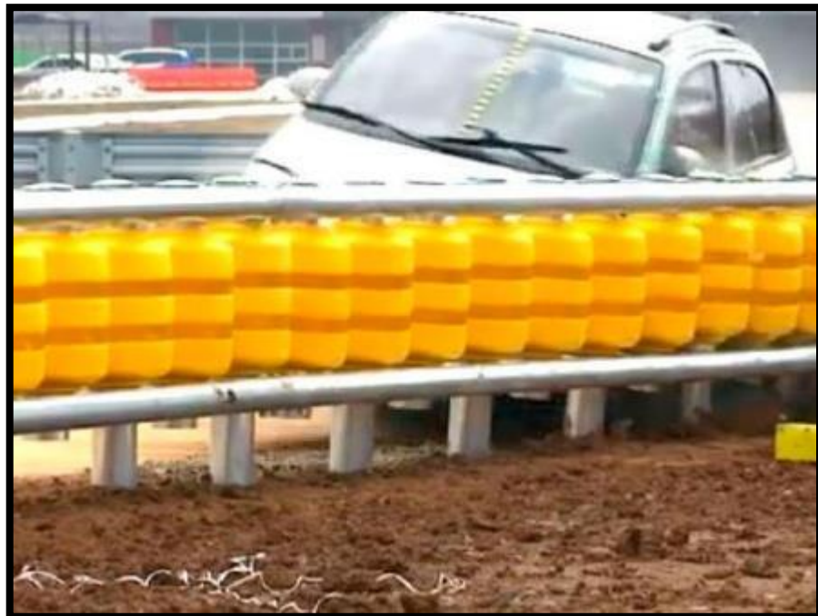
Figura 32. Choque vehículo contra Roller Barrier System
