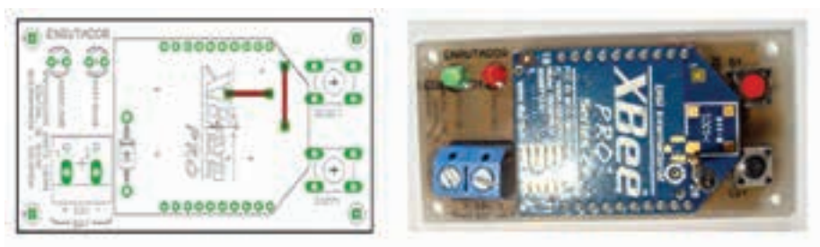
Figura 10. Esquemático y tarjeta real módulo router
