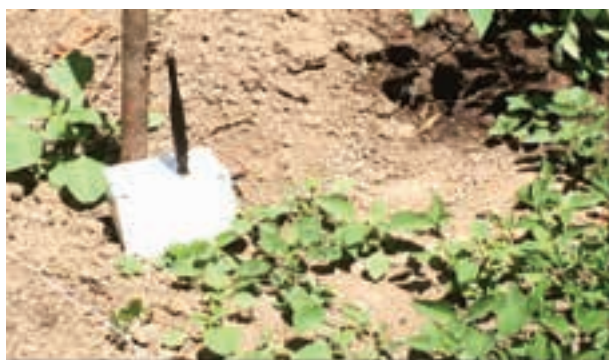
Figura 13. Nodos de medición en carcasa resistente a cambios climáticos
