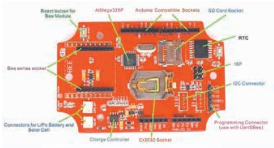
Figura 4. Principales elementos de la tarjeta base nodo BSN-DRN
