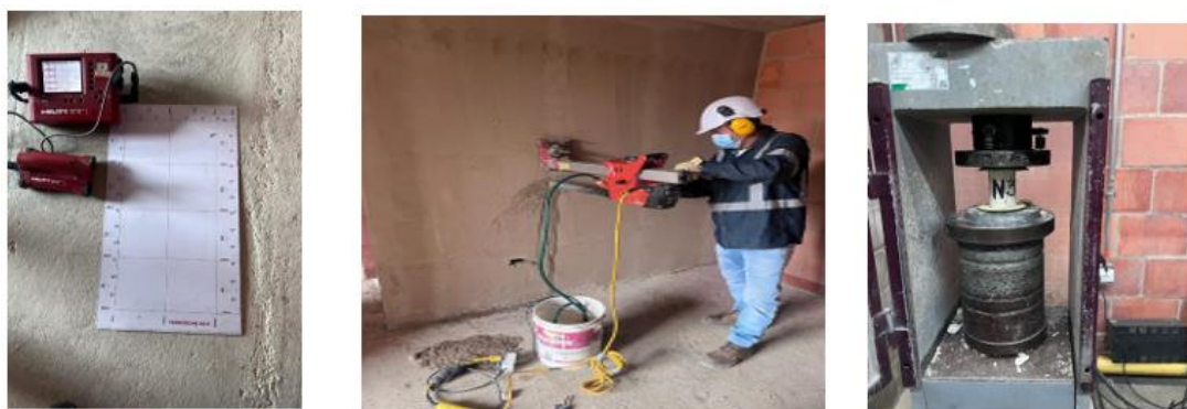
Figura 8 Ensayo de extracción de núcleos laboratorio PROCEMCO
