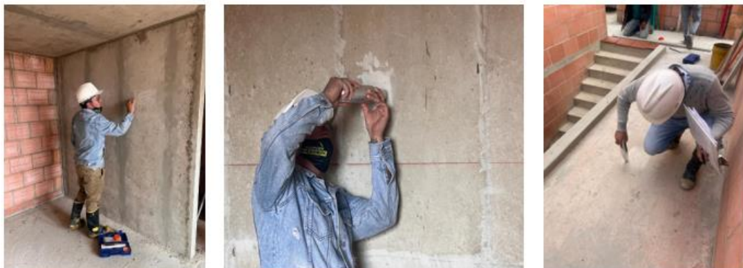
Figura 6 Ensayo de esclerómetro
