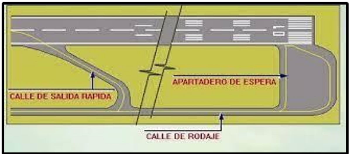
Figura 7. Calle de salida rápida, calle de rodaje y apartadero de espera, de un aeropuerto
