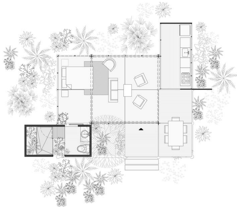
Figura 10. Planta arquitectónica iku habitat
