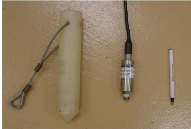
Figura 69. Transductor Sensotec presión de poro con el cono de nylon.
