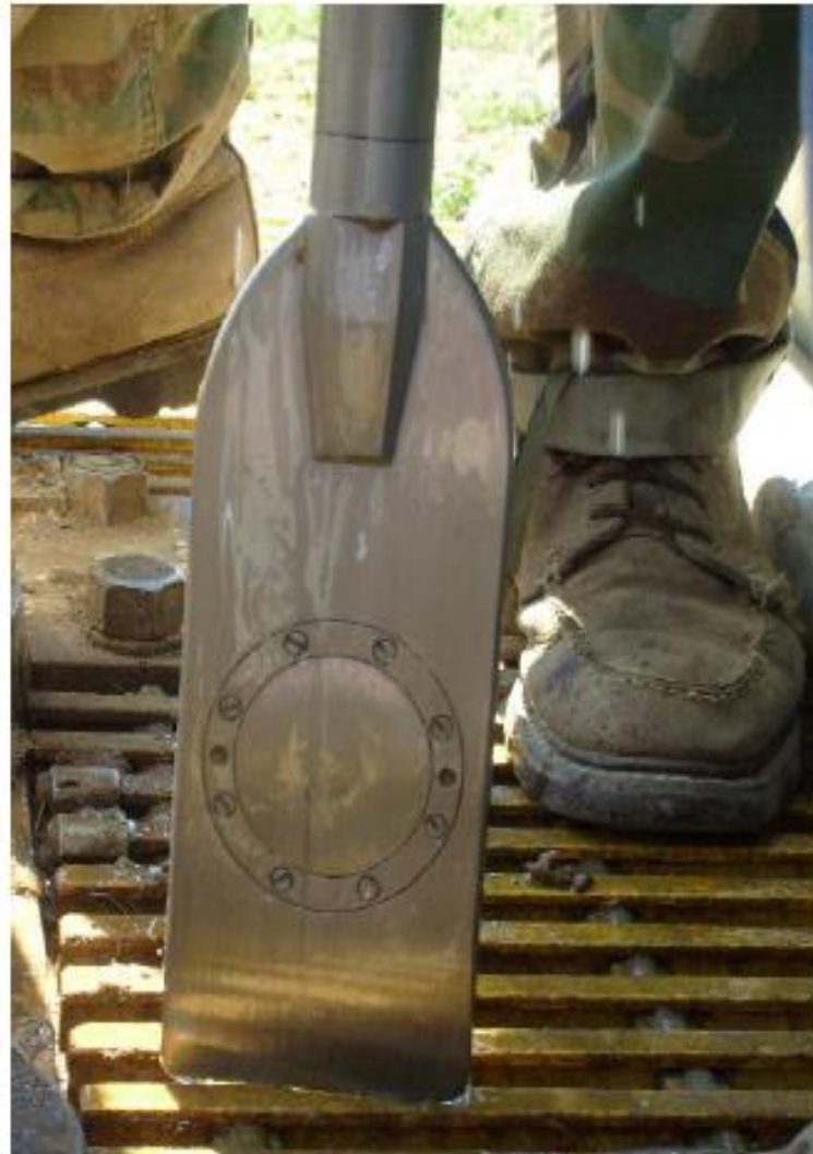
Figura 67. Hoja Dilotometer (foto cortesía de Romano Hryciw).
