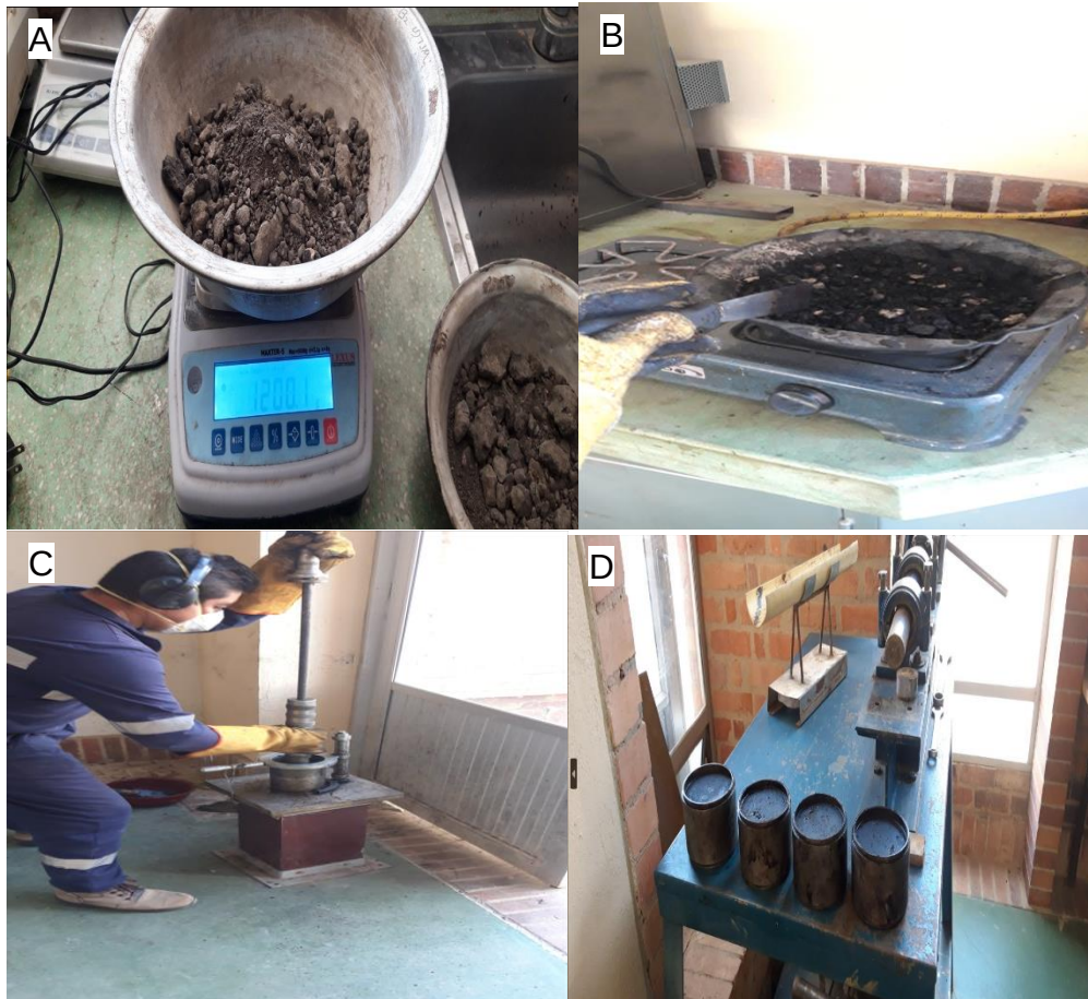
Fig. 37 - Proceso de fabricación briquetas ensayo estabilidad y flujo.
