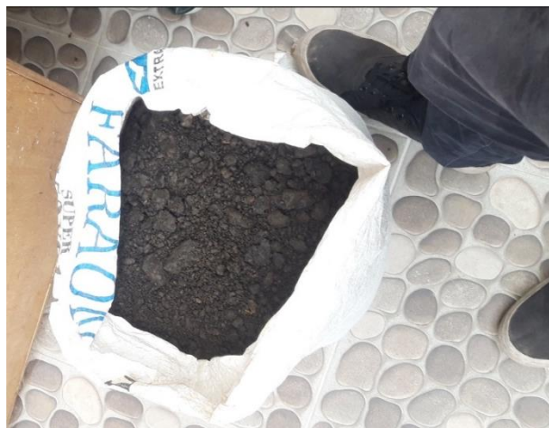
Fig. 26- Material R.A.P para laboratorios.
