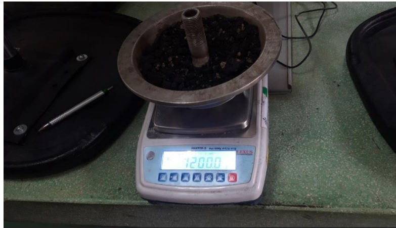
Fig. 30- Masa muestra RAP ensayo % de asfalto.
