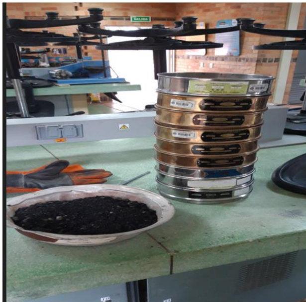
Fig. 34- Tamices y muestra para granulometría.
