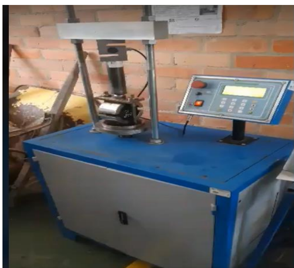
Fig. 41- Briqueta N1 en equipo Marshall.
