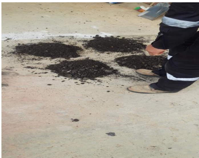
Fig. 28- Cuarteo de Material Para laboratorios
