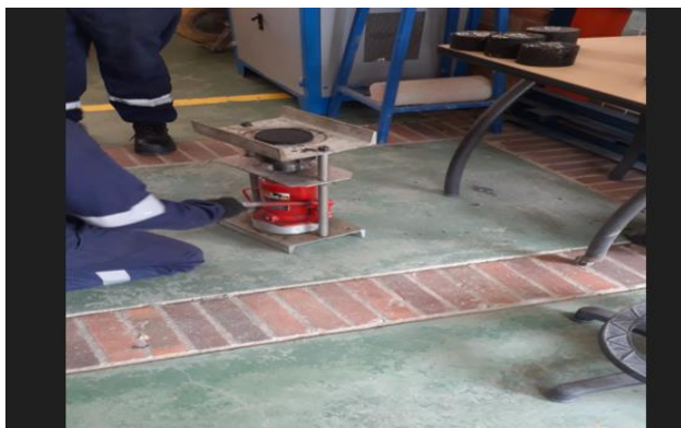
Fig. 38- extracción de probetas.
