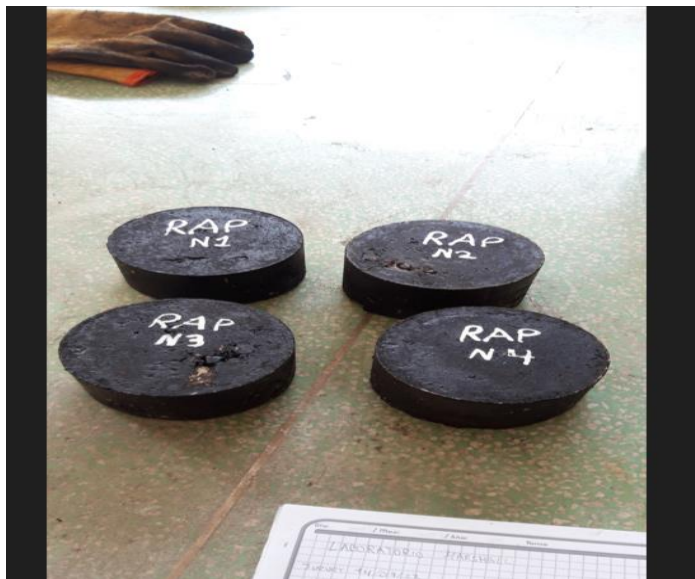
Fig. 39- Briquetas terminadas N1 a N4.
