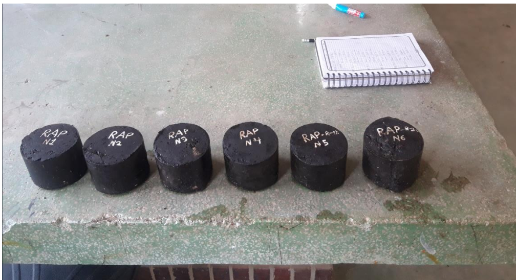
Fig. 43- Briquetas N1-N6 Falladas.
