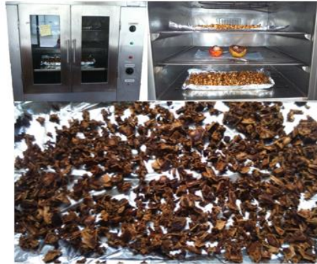
Figura 8. Horno de calor recirculante para retirar humedad de la muestra.
