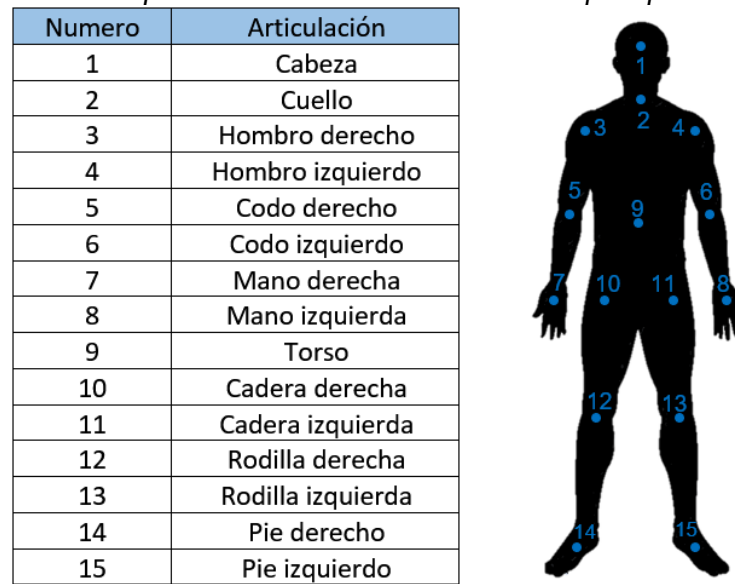
Figura 32. Puntos articulares que reconoce el Kinect usando SimpleOpenNI
