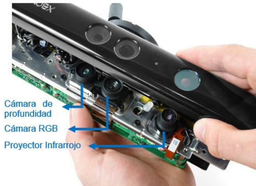
Figura 26. Partes del Kinect
