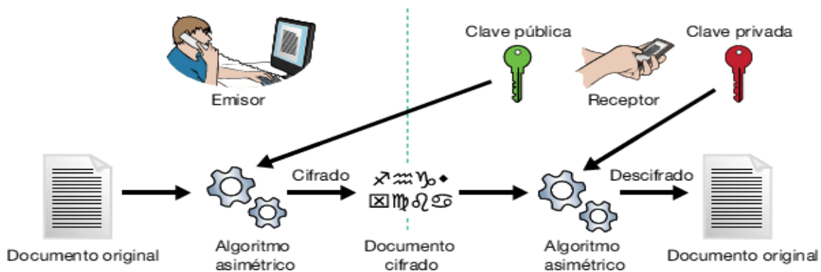
Figura 1 Criptografía asimétrica. Extraída [6]
