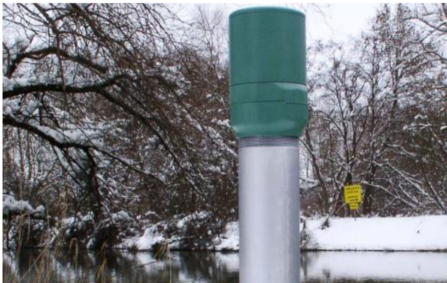
Figura 18. Alerta de inundaciones SEBA. Fuente: Seba hydrometrie (2013).
