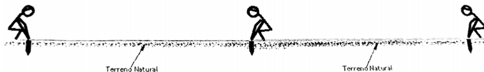
Figura 2. Doble medición con cinta en terreno plano.
