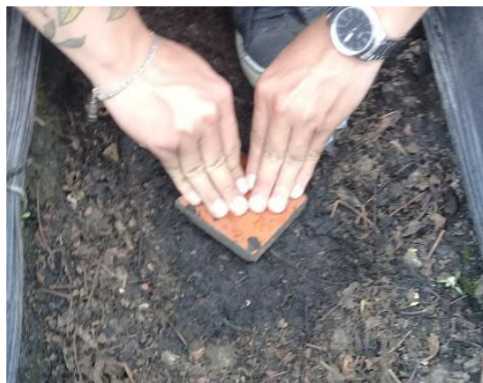
Figura 4-14. Recolección de muestras con cilindro
