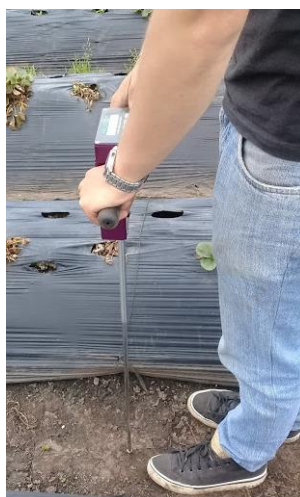
Figura 4-16. Prueba de compactación del suelo
