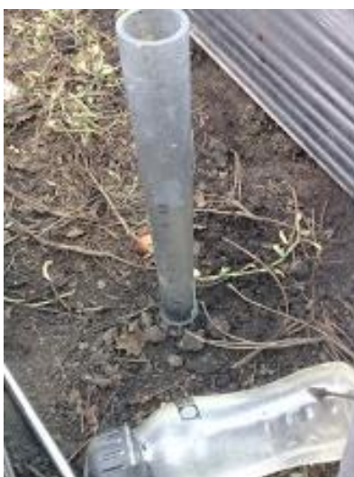
Figura 4-13. Prueba de infiltración por infiltrómetro
