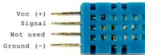
Figura 8. Sensor de Temperatura y Humedad DHT11 con pines. [16]
